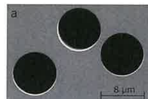
電子顕微鏡写真からポアの均一な分布とサイズを確認できます。
